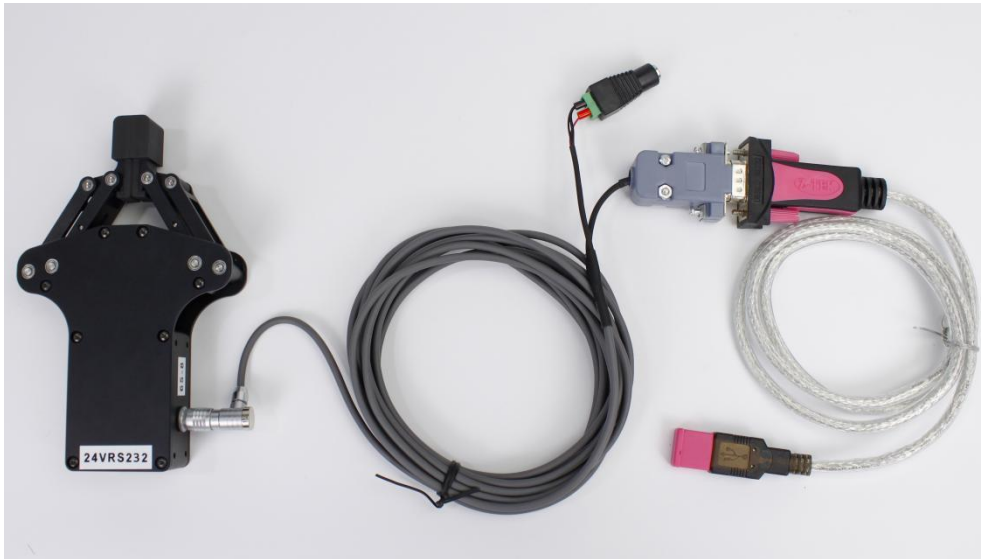
RS232 测试线与夹爪接口连接示意图
