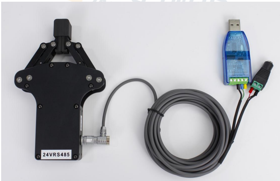
RS485 测试线与夹爪接口连接示意图
