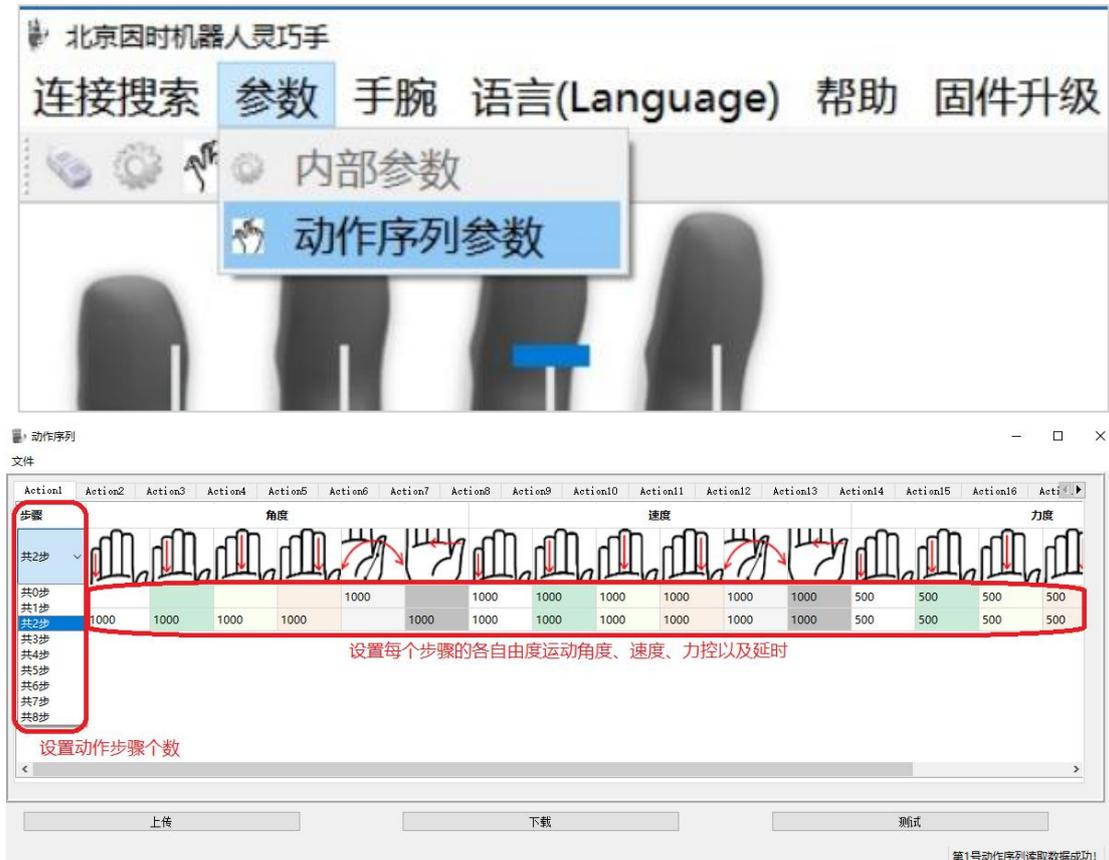
本软件可以设置灵巧手内部第 1-第 13 套动作序列数据，每套动作序列最多能有 8 步分解动作，每一步分解动作的手指角度、运动速度、力度以及等待时间都可以单独设置。
