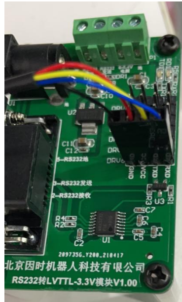
RS232 转换器正确接线示意图
