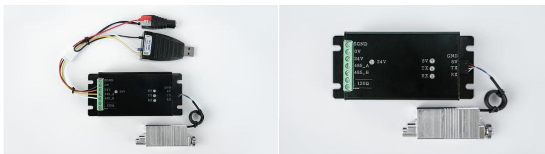
Modbus 转换器、测试线缆、电缸连接示意图
